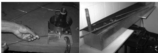
Figuras 6 e 7 – Corte cilíndrico e cozimento de fios de PET.
